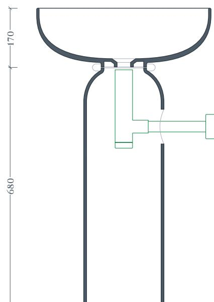
N.B. Le misure indicate possono subire una variazione dell 0,6% circa, dovuta ad usura stampi e a variazioni delle caratteristiche tecniche relative alle materie prime che compongono l'impasto .
