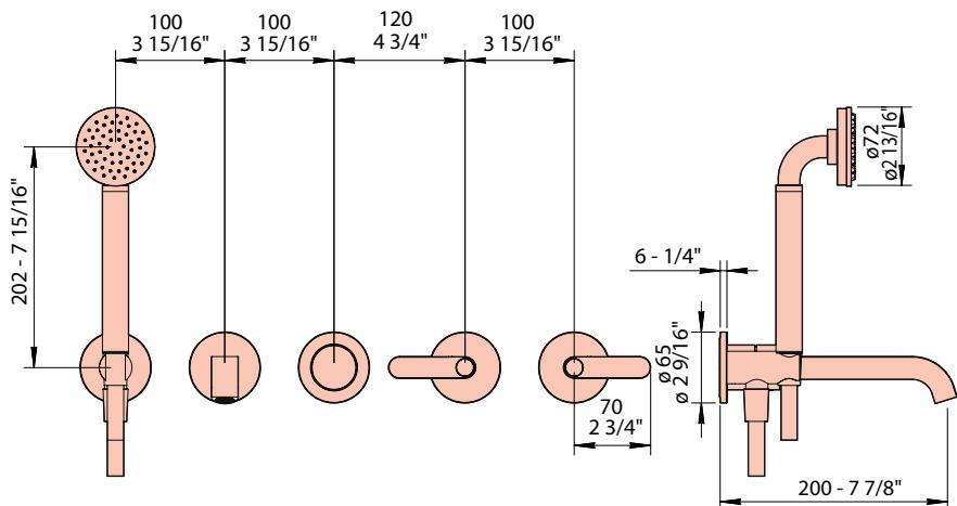
**IT** Questi miscelatori possono essere utilizzati con accumulatori di acqua calda a pressione o con scaldabagni istantaneei.
