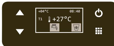
Premere e tenere premuto il tasto acqua liscia fredda sul rubinetto. Rilasciare il tasto una volta avviata l'erogazione, a Display compare la seguente schermata. / Press and hold the cold still water button on the tap. Release the button once dispensing has started, the following screen will appear on the display.
