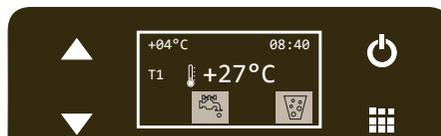
Premere e tenere premuto il tasto acqua gassata fredda sul rubinetto. Rilasciare il tasto una volta avviata l'erogazione, a Display compare la seguente videata. Premere nuovamente il tasto sul rubinetto una volta raggiunta la dose d'acqua desiderata. / Press and hold the cold sparkling water button on the tap. Release the button once dispensing has started, the following screen will appear on the display. Press the button on the tap again once you have reached the desired amount of water.
