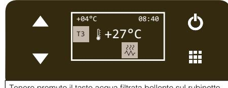
Tenere premuto il tasto acqua filtrata bollente sul rubinetto e premere il tasto acqua filtrata liscia fredda per attivare il Boiler alla temperatura T3, quando questo si trova impostato invece su T1 o T2. / Hold down the boiling filtered water button on the tap and press the cold still filtered water button to activate the boiler at temperature T3, when this is instead set to T1 or T2.
