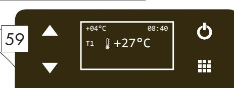
Partire dalla schermata iniziale per programmare le dosi di acqua filtrata liscia e gassata fredda. / Start from the initial screen to program the doses of cold still and sparkling filtered water.
