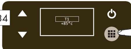
Premere e verificare che la scritta T1 inizia a lampeggiare. / Press and check that T1 starts flashing.
