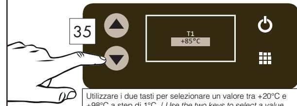
Utilizzare i due tasti per selezionare un valore tra +20°C e +98°C a step di 1°C. / Use the two keys to select a value between +68°F and +208.4°F in steps of 33.8°F.
