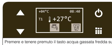
Premere e tenere premuto il tasto acqua gassata fredda sul rubinetto. Rilasciare il tasto una volta avviata l'erogazione, a Display compare la seguente videata. Premere nuovamente il tasto sul rubinetto una volta raggiunta la dose d'acqua desiderata. / Press and hold the cold sparkling water button on the tap. Release the button once dispensing has started, the following screen will appear on the display. Press the button on the tap again once you have reached the desired amount of water.
