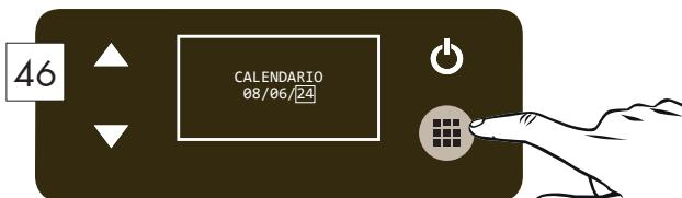
Premere per confermare la scelta. Verificare che il lampeggio passi al parametro a fianco. / Press to confirm your choice. Check that the flashing shifts to the next parameter.
