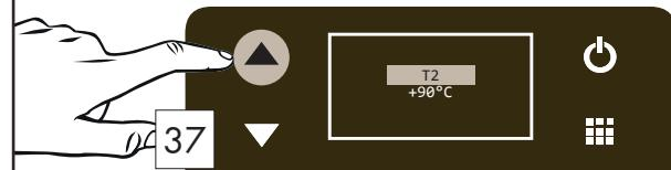
Premere per passare al parametro T2 o T3. Ripetere i passaggi da vignetta 40 per modificare le temperature. / Press to move to parameter T2 or T3. Repeat the steps from panel 40 to change the temperatures.
