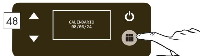
Premere per confermare la scelta. Verificare che il lampeggio passi nella schermata OROLOGIO in corrispondenza delle ore. / Press to confirm your choice. Check that the flashing shifts to the CLOCK screen corresponding to the hours.
