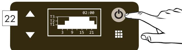
Tenere premuto per 2 secondi per salvare la sequenza del termostato. Il grafico in figura è un semplice esempio. / Press and hold for 2 seconds to save the thermostat sequence. The graph in the figure is a simple example.
