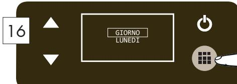
Premere per modificare il parametro. Verificare che la scritta GIORNO inizia a lampeggiare. / Press to modify the parameter. Check that the word DAY starts flashing.
