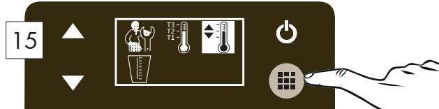
Premere il tasto dopo aver selezionato l'icona per modificare la programmazione settimanale delle temperature del boiler. / Press the button after selecting the icon to change the weekly programming of the boiler temperatures
