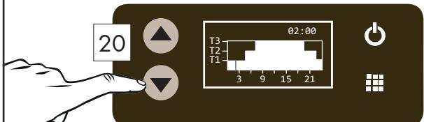
Utilizzare i due tasti per selezionare l'orario (step di 30 minuti) di cui si vuole modificare il SET TEMPERATURA tra T1, T2, T3. In alto a destra viene riportata l'ora in fase di impostazione. La "fascia oraria" in oggetto lampeggia. / Use the two keys to select the time (30 minute steps) for which you want to change the SET TEMPERATURE between T1, T2, T3. The time being set is shown at the top right. The "time band" in question flashes.
