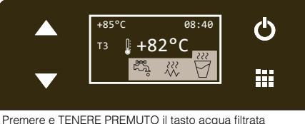
Premere e TENERE PREMUTO il tasto acqua filtrata bollente sul rubinetto per tutta la durata dell'erogazione (a Display compare la seguente videata). Rilasciare il tasto una volta raggiunta la dose d'acqua desiderata. / Press and HOLD the filtered boiling water button on the tap for the entire duration of dispensing (the following will screen appears on the display). Release the button once you have reached the desired amount of water.
