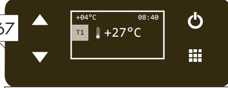
Partire dalla schermata iniziale per attivare temporaneamente il Boiler alla temperatura T3. La macchina è in questo momento programmata su T1 o T2. / Start from the home screen to temporarily activate the boiler at temperature T3. The machine is currently programmed to T1 or T2.
