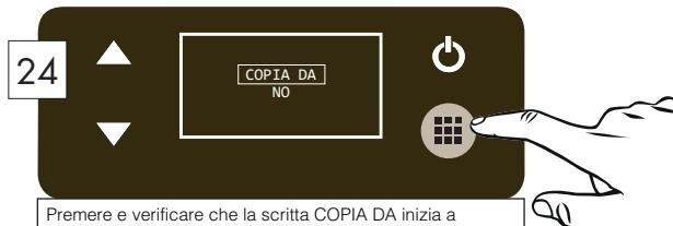
Premere e verificare che la scritta COPIA DA inizia a lampeggiare. / Press and check that COPY FROM starts flashing.
