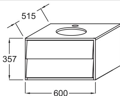
Description : Meuble 60 cm sous vasque à poser. EB762. Collection : ESCALE. Dimensions : 60 x 51,5 x 35,7 cm. Poids : 23,2 kg. Matériau : Laque. Installation : Suspendu. Rangement : 1 tiroir à fermeture progressive. Uniquement en finition gris titane ou noir brillant. Équipé d'un plateau en verre laqué blanc. ROBINETTERIE CONSEILLÉE : Le mitigeur élégant et racé Margaux et son levier joystick ou le mitigeur Purist au design audacieux.
