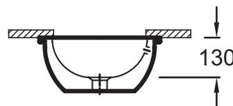
Description : Vasque rectangulaire à encastrer par-dessous 56 x 39,5 cm, avec trou de trop-plein. EYA102. Collection : VOX. Dimensions : 56 x 39,5 cm. Poids : 15 kg. Matériau : Céramique. Installation : Encastré par-dessous. LIVRÉ AVEC : Kit de fixation. Avec trou de trop-plein à l'avant. Sans cache trop-plein.
