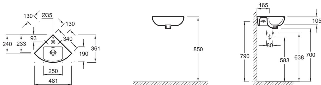
Description : Lave-mains d'angle 34 cm. E4733. Collection : ODÉON UP. Dimensions : 34 x 34 cm. Poids : 7 kg. Matériau : Céramique. Installation : Autoportant. Percement robinetterie : Percé 1 trou de robinetterie. ROBINETTERIE CONSEILLÉE : Aleo, une gamme design très accessible. Livré avec cache trop-plein chromé.
