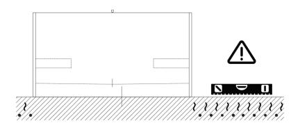
La vasca deve essere installata su un pavimento perfettamente piano. The bathtub must be positioned on a flat floor surface.
