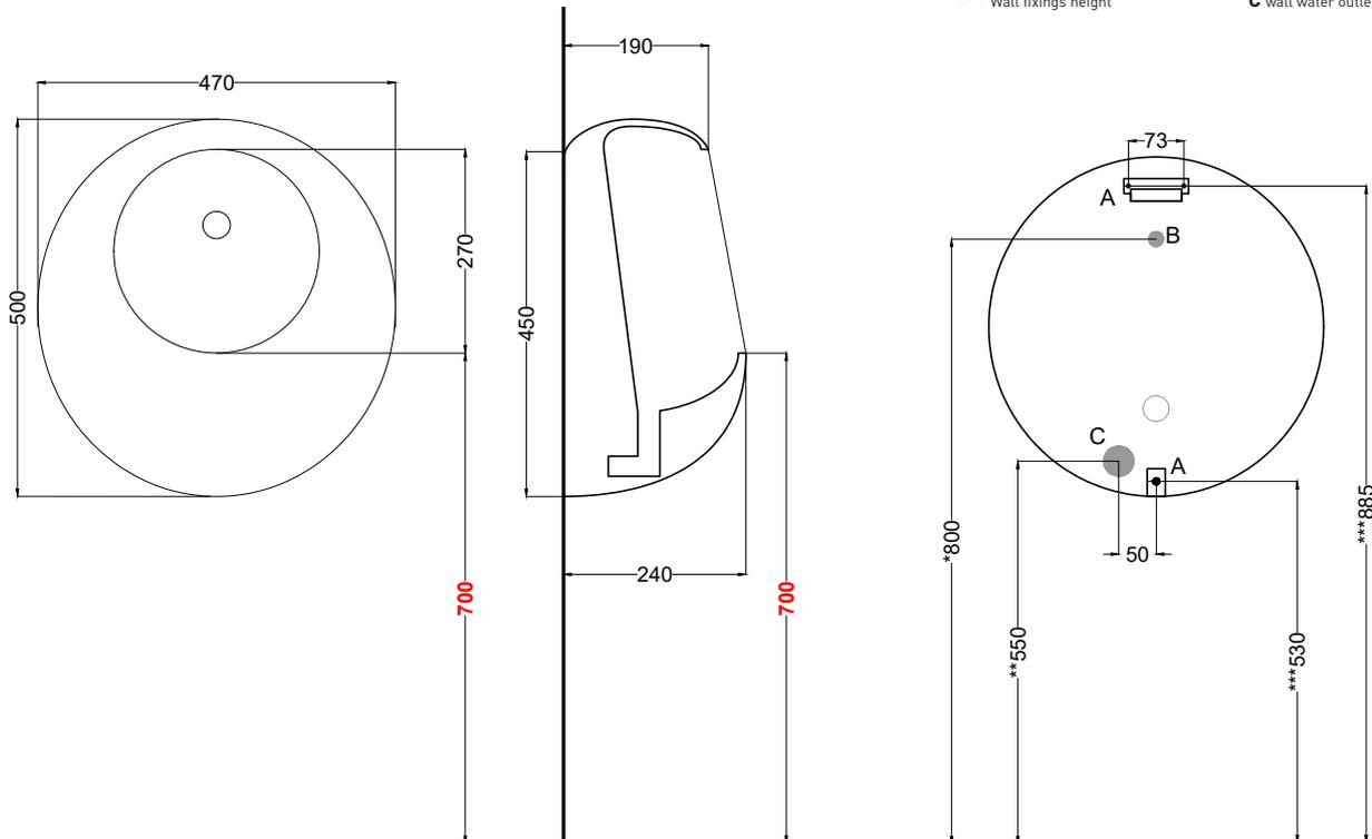
**ATTENZIONE:** L'orinatoio non è dotato di meccanismo di scarico che va acquistato a parte sulla base delle esigenze del cliente. Il meccanismo può essere sia manuale che elettronico, deve prevedere una bassa pressione di esercizio e un attacco con un flessibile (non in dotazione) di 1/2". Si consiglia di verificare gli attacchi e le capacità di scarico prima di procedere alla chiusura del cantiere e provvedere agli aggiustamenti tecnici necessari.
