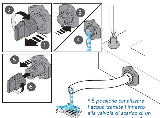
\* È possibile canalizzare l'acqua tramite l'innesco alla valvola di scarico di un comune tubo da giardino
