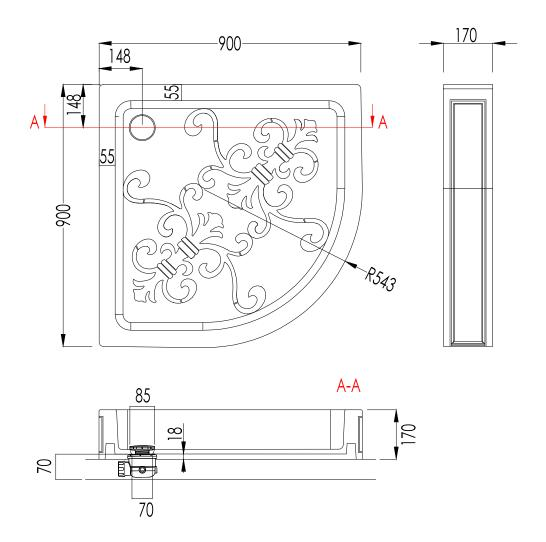
\*con piletta sifonata SFAD200 prevedere un incavo di circa 70 mm in corrispondenza del foro della piletta \*with the siphoned drain SFAD200 calculate a recess of 70 mm in correspondence of the waste hole
