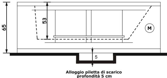
Motore Idromassaggio (M) Whirlpool Motor
