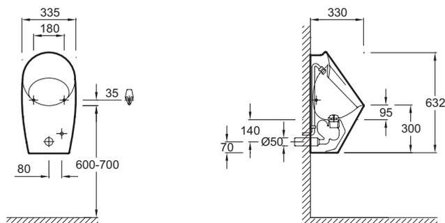
Description : Urinoir à action siphonique. E1548. Collection : PATIO. Dimensions : 30 x 62 x 32 cm. Poids : 17,5 kg. Matériau : Céramique. Installation : Mural. Alimentation encastrée, évacuation encastrée, livré avec équipement complet (fixation E4598, effet d'eau E74203, flexible E74187, bonde à grille E78166, siphon S.H. E6333).
