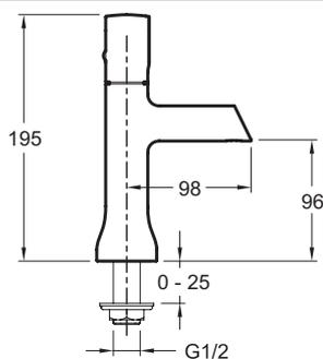
Description : Robinet lave-mains.. E8967. Collection : TOOBI. Poids : 1,1 kg. Installation : 1 trou. Normes : ACS : 15 ACC LY 081. Débit : 8 l/mn sous 3 bars. Mécanisme : Cartouche à disque en céramique de 25 mm.
