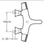
Description: Mitigeur thermostatique bain-douche mural. E71684. Collection: SYMBOL. Poids: 4,5 kg. Installation: Mural. Débit: 20,5 l/mn sous 3 bars. Raccords: Avec raccords et rosaces murales. Mécanisme: Cartouche thermostatique à cire dilatable. Entraxe: 150 ± 15 mm. Luxe, élégance et fluidité. Clapets anti-retour sur les alimentations. Aérateur anti-calcaire intégré.
