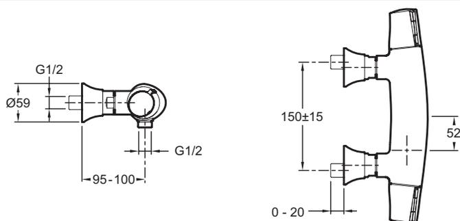
Description : Mitigeur thermostatique douche mural. E71683. Collection : SYMBOL. Poids : 3,7 kg. Installation : Mural. Débit : 18 l/mn sous 3 bars. Raccords : Avec raccords et rosaces murales. Mécanisme : Cartouche thermostatique à cire dilatable. Entraxe : 150 ± 15 mm. Luxe, élégance et fluidité. Clapets anti-retour sur les alimentations.
