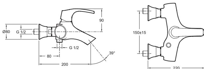
Description : Mitigeur bain-douche mural. E71680. Collection : SYMBOL. Poids : 3,9 kg. Installation : Mural. Débit : 20 l/mn sous 3 bars. Raccords : Avec raccords et rosaces murales. Mécanisme : Cartouche à disques céramique. Entraxe : 150 ± 15 mm. Luxe, élégance et fluidité. Clapets anti-retour sur les alimentations. Aérateur anti-calcaire intégré.
