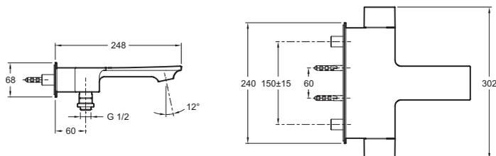
Description : Mitigeur thermostatique bain-douche mural. E9103. Collection : STANCE. Poids : 3,5 kg. Installation : Mural. Raccords : Avec raccords muraux. Mécanisme : Cartouche thermostatique à dire dilatable. Entraxe : 150 +/- 15 mm. Aérateur anti-calcaire. Clapets anti-retour sur es alimentations.
