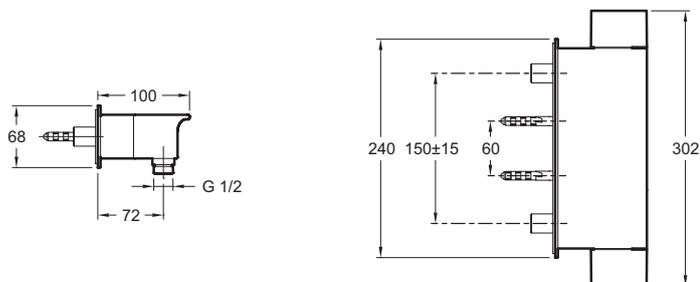
Description : Mélangeur douche mural. E9102. Collection : STANCE. Poids : 3,8 kg. Raccords : Avec raccords muraux. Clapets anti-retour sur la sortie douche.
