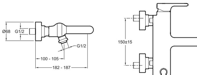
Description : Mitigeur bain-douche mural.. E10867. Collection : SINGULIER. Poids : 3,8 kg. Installation : Mural. Normes : NF : II/A - ECAU : E3/1 C2 A1 U3. Débit : 20 l/mn sous 3 bars. Raccords : Avec raccords et rosaces murales. Mécanisme : Cartouche à disques céramique. Entraxe :  $150 \pm 15$  mm.
