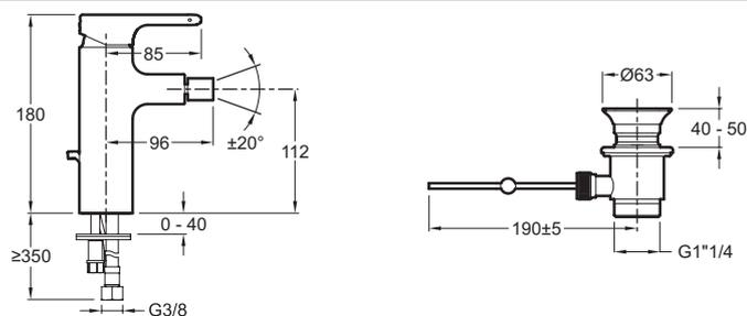
Description : Mitigeur bidet avec flexibles d'alimentation.. E10865. Collection : SINGULIER. Poids : 2,1 kg. Installation : 1 trou. Normes : NF : I - ECAU : E0 C2 A2 U3 - Ge3. Débit : 13 l/mn sous 3 bars. Raccords : Avec flexibles d'alimentation. Mécanisme : Cartouche à disques céramique.
