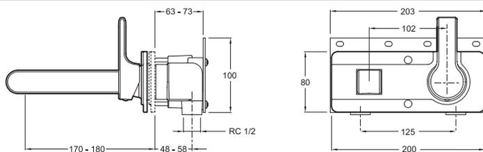
Description : Mitigeur lavabo mural.. E10863. Collection : SINGULIER. Poids : 3,6 kg. Installation : Mural. Débit : 14 l/mn sous 3 bars. Mécanisme : Cartouche à disques céramique avec limiteur de débit. Limiteur de débit sensitif.
