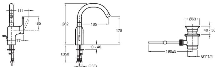
Description : Mitigeur lavabo, bed tube, avec flexibles d'alimentation.. E10862. Collection : SINGULIER. Poids : 2,1 kg. Installation : 1 trou. Normes : NF : IIB - ECAU : E0 C2 A1 U3. Débit : 15 l/mn sous 3 bars. Raccords : Avec flexibles d'alimentation. Mécanisme : Cartouche à disques céramique.
