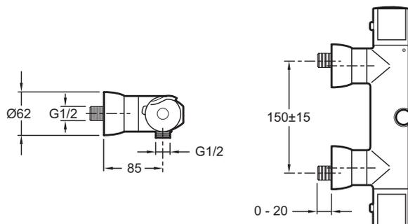
Description : Mitigeur thermostatique douche mural. E71089. Collection : SALUTE. Poids : 3,5 kg. Installation : Mural. Débit : 19 l/mn sous 3 bars. Raccords : Avec raccords et rosaces murales. Mécanisme : Cartouche thermostatique à cire dilatable avec limiteur de température/débit. Entraxe : 150 ± 15 mm. Butée de sécurité à 40°, blocage température maxi à 50° C. Clapets anti-retour sur es alimentations. Support de douchette intégré.
