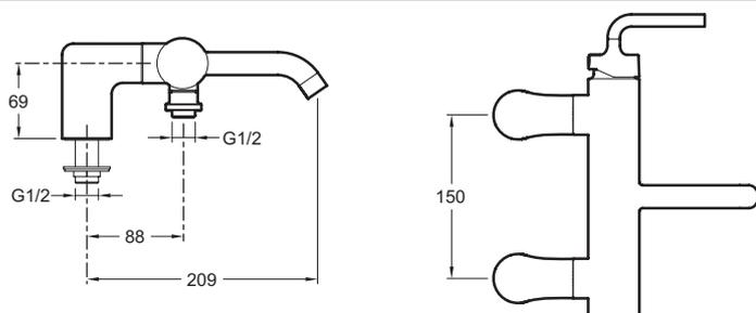
Description : Mitigeur bain-douche sur gorge.. E14500-4A. Collection : PURIST. Poids : 4,5 kg. Installation : 2 trous. Débit : 23 l/mn sous 3 bars. Raccords : Avec raccords colonnettes. Mécanisme : Cartouche à disques céramique. Entraxe : 150 mm.
