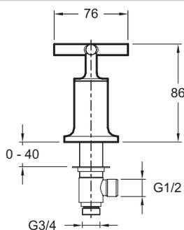
Description : Kit 2 poignées/têtes pour mélangeur bain.. E144293. Collection : PURIST. Poids : 2,7 kg. Normes : ACS : 15 ACC LY 081. Débit : 43 l/mn. Mécanisme : Têtes à disques céramique. Une robinetterie minimaliste et noble.
