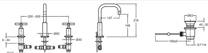
Description : Mélangeur lavabo 3 trous, bec fixe.. E144063. Collection : PURIST. Poids : 3,5 kg. Installation : 3 trous. Normes : ACS : 15 ACC LY 081. Débit : 10 l/mn. Mécanisme : Têtes à disques céramique.
