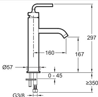
Description : Mitigeur lavabo - modèle haut - avec flexibles d'alimentation.. E14404-4A. Collection : PURIST. Poids : 3,4 kg. Installation : 1 trou. Débit : 7 l/mn sous 3 bars. Raccords : Avec flexibles d'alimentation. Mécanisme : Cartouche à disques céramique.
