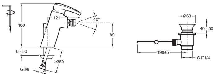
Description : Mitigeur bidet. E73240. Collection : PANACHE. Poids : 1,8 kg. Installation : 1 trou. Normes : NF : I - ECAU : E0 C2 A3 U3 - Ge3. Débit : 12 l/mn sous 3 bars. Raccords : Avec flexibles d'alimentation. Mécanisme : Cartouche à disques céramique avec limiteur de débit. Bonde de vidage.
