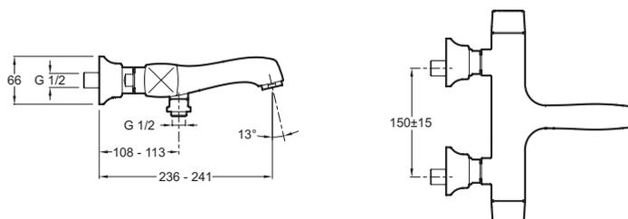
Description : Mélangeur bain-douche mural. E16219-9. Collection : MARGAUX. Poids : 4,5 kg. Installation : Mural. Normes : ACS : 15 ACC LY 081. Mécanisme : Têtes à disques céramique. Entraxe : 150 ± 15 mm. Inverseur automatique discret. Clapet anti-retour sur sortie douche. Aérateur anti-calcaire.
