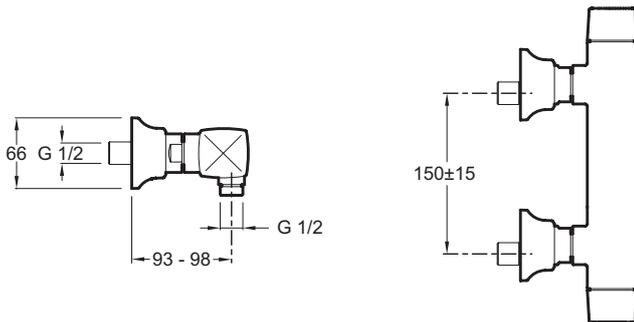
Description : Mitigeur thermostatique douche mural. E16218-9. Collection : MARGAUX. Poids : 3,7 kg. Installation : Mural. Débit : 13 l/mn. Raccords : Avec raccords et rosaces murales. Entraxe : 150 ± 15 mm. Butée de sécurité à 38°C, température maxi à 50°C. Clapet anti-retour sur alimentations.
