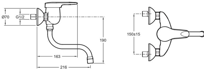
Description : Mitigeur évier mural. E659. Collection : CANDIDE. Poids : 1,9 kg. Installation : Mural. Normes : NF : I - ECAU : E0 C2 A2 U3 - Ge3 - ACS : 11ACCLY540. Débit : 10 l/mn sous 3 bars. Raccords : Avec raccords et rosaces murales. Mécanisme : Cartouche à disques céramique avec limiteur de débit. Entraxe :  $150 \pm 15$  mm. Corps monobloc, absence de coupelle sous le levier.
