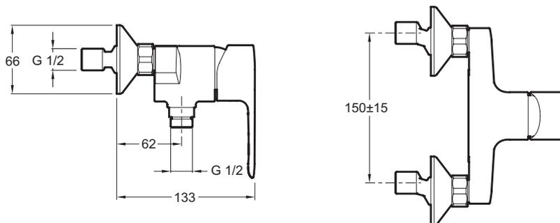
Description : Mitigeur douche mural.. E16029-4. Collection : JULY. Poids : 1,4 kg. Normes : NF : IA - ECAU : E1 C2 A3 U3 - Ge3. Débit : 14 l/mn sous 3 bars. Mécanisme : Cartouche à disques céramique avec de débit. Entraxe : 150 ± 15 mm.
