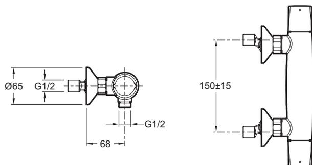
Description : Mélangeur douche mural.. E18877. Collection : ELEVATION. Poids : 2,1 kg. Installation : Mural. Débit : 15 l/mn sous 3 bars. Raccords : Avec raccords et rosaces murales. Mécanisme : Têtes à disques céramique.
