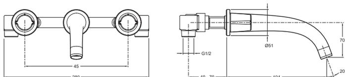
Description : Mélangeur lavabo mural 3 trous.. E18872. Collection : ELEVATION. Poids : 3,2 kg. Installation : Mural. Normes : ACS : 15 ACC LY 085. Débit : 13,5 l/mn sous 3 bars. Mécanisme : Têtes à disques céramique. Entraxe : 200 mm.
