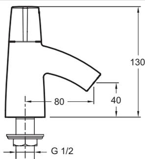
Description : Robinet indépendant de lave-mains (eau froide). E12817-7. Collection : ELEVATION. Poids : 0,8 kg. Installation : 1 trou. Normes : ACS : 15 ACC LY 081. Débit : 8 l/mn sous 3 bars. Mécanisme : Tête à disques céramique. Brise-jet anti-calcaire intégré.
