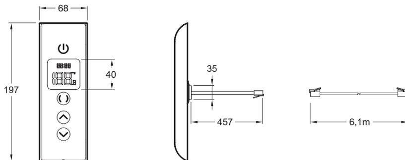
Description : Interface digitale. 527D. Collection : DTV PROMPT. Dimensions : 19.7 x 6.8 x 1.9 cm. Poids : 1 kg. Installation : Mural. Préchauffage : la douche est mise en eau jusqu'à la température souhaitée, puis se met en pause jusqu'à l'entrée dans la douche.
