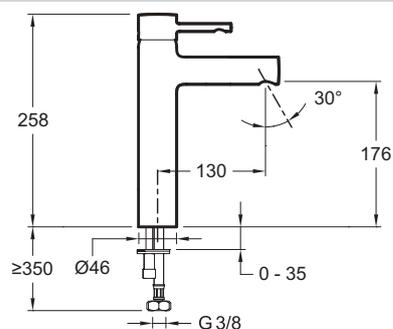
Description : Mitigeur lavabo - modèle Haut - corps lisse, sans tirette.. E98299. Collection : CÜFF. Poids : 1,8 kg. Installation : 1 trou. Normes : ACS (Attestation Conformité Sanitaire) : 10 ACC LY 004. Débit : 5 l/mn. Hauteur totale du robinet : 258 mm. Raccords : Avec flexibles d'alimentation. Mécanisme : Cartouche à disques céramique.
