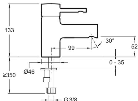
Description : Mitigeur lavabo - modèle Standard - corps lisse, sans tirette, sans vidage.. E98297. Collection : CÜFF. Poids : 1,1 kg. Installation : 1 trou. Normes : NF : I - ECAU : E00Ch2A3U3 - ACS : 10 ACC LY 004. Débit : 5 l/mn sous 3 bars. Hauteur totale du robinet : 133 mm. Raccords : Avec flexibles d'alimentation. Mécanisme : Cartouche à disques céramique.
