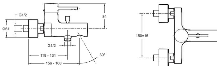
Description : Mitigeur bain-douche mural.. E45532. Collection : CÜFF. Poids : 2,6 kg. Installation : Mural. Normes : NF : IC/A - ECAU : E3/1 C A2 U3 - ACS : 10 ACC LY 004. Débit : 22 l/mn sous 3 bars. Raccords : Avec raccords et rosaces murales. Mécanisme : Cartouche à disques céramique. Entraxe :  $150 \pm 15$  mm.
