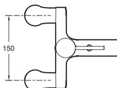
Description : Mitigeur bain-douche sur gorge.. E37043. Collection : CÜFF. Poids : 3 kg. Normes : NF : IC/A - ECAU : E3/1 C2 A2 U3 - ACS : 10 ACC LY 004. Débit : 20 l/mn sous 3 bars.. Raccords : Avec raccords colonnettes. Mécanisme : Cartouche à disques céramique. Entraxe : 150 mm.
