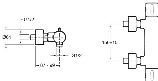
Description : Mitigeur thermostatique douche mural.. E37035. Collection : CÜFF. Poids : 2,8 kg. Installation : Mural. Normes : ACS (Attestation Conformité Sanitaire) : 10 ACC LY 102. Raccords : Avec raccords et rosaces murales. Mécanisme : Cartouche à cire dilatable. Entraxe : 150 ± 15 mm.
