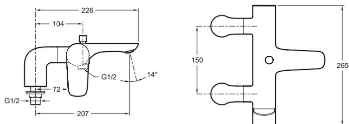
Description : Mitigeur bain-douche sur gorge.. E72283. Collection : ALEO. Poids : 3 kg. Normes : ACS (Attestation Conformité Sanitaire) : 10 ACC LY 113. Raccords : Avec raccords colonnettes. Mécanisme : Cartouche à disques céramique. Entraxe : 150 ± 15 mm.
