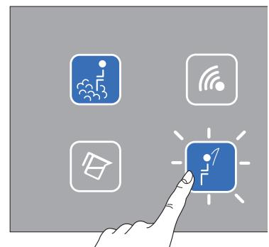
► Нажимая данную клавишу в течение нескольких секунд, можно активировать форсунку (или водопад) холодной воды короткой длительности, происходящий из отверстия на верхней части панели, в которой размещена арматура.
