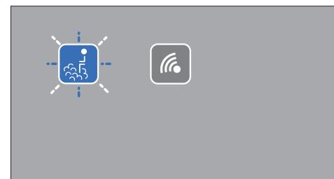
**mod. TT :** les touches "alarme" et "bain turc" restent allumées (lumière blanche), tandis que la troisième led en partant du haut clignote. La fonction (bain turc ou cycle anti-calcaire) est interrompue.
