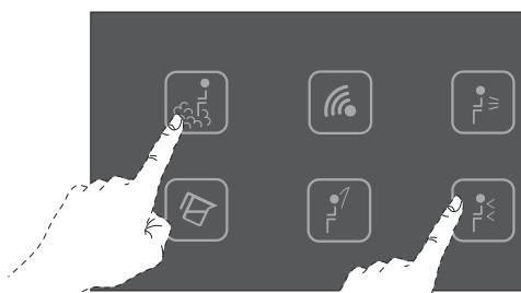
*Il pannello di controllo presenta tutti i tasti illuminati con luce bianca, ad intensità ridotta.*
