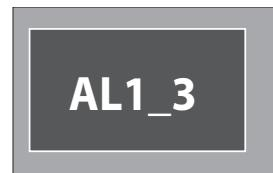
Wenn die Anomalien mit den Codes "AL1\_X" länger als 30 Sekunden vorliegen, werden die entsprechende Funktion (oder Funktionen) abgebrochen (ausgenommen Entkalkungszyklus).
