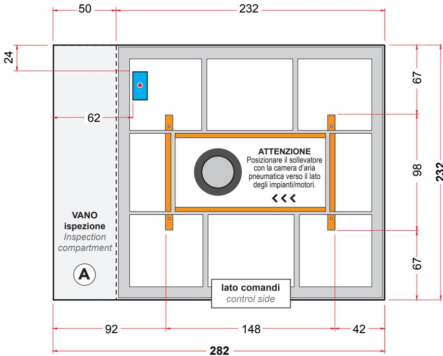
PROVVEDERE AL FISSAGGIO A TERRA DEL SOLLEVATORE SOLO DOPO AVER FATTO LA PROVA DI ESCURSIONE CON IL SOLO CONTROTELAIO.
